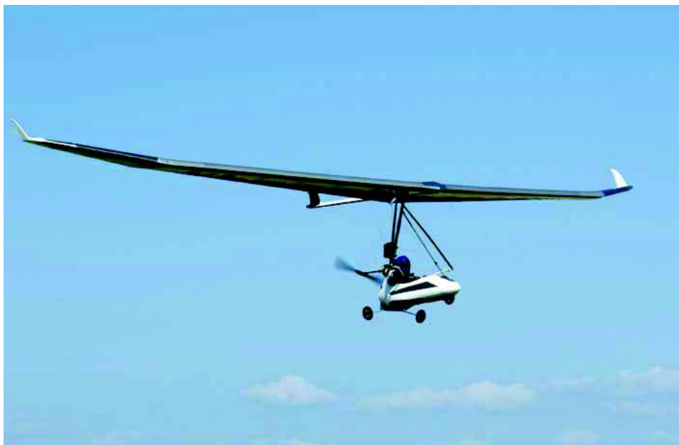
Oben: Trike der tschechischen Firma Ultralight-Design mit 15-kW-Geiger-Motor
