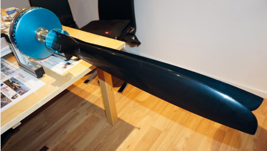
Klapppropeller – perfekt für den Einsatz eines käfiglosen Paramotorsystems, einer E- Aufstiegs- hilfe
