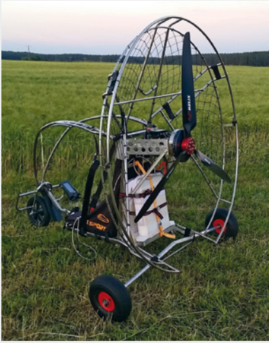
Einsitzertrike mit dem Geiger Antriebsset mit zwei Akkupacks
