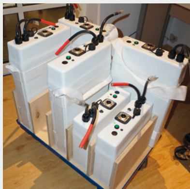
Akkupacks – zur Wahl stehen Hochstromzellen und Hochkapazitätszellen in verschiedenen konfigurierten Akkupacks von 25 bis 68 Ah
