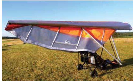
„Hat Platz in der kleinsten Hütte“ – beinahe. Aus diesem Zustand ist das Ultraleicht in fünf Minuten startbereit.
