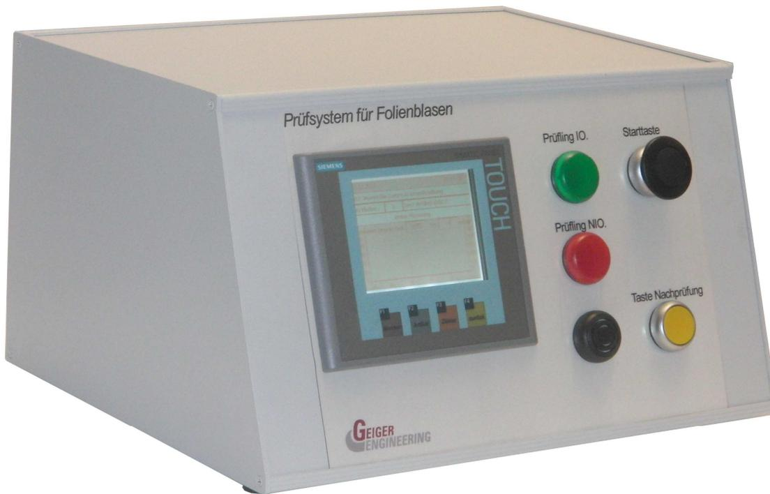
Mit dem Starttaster wird die Prüfung gestartet. Darauf hin wird der Zylinder für den Blasensanschluss in die Füllposition gefahren. Hat der Zylinder die vordere Endlage erreicht, beginnt das Zyklenprüfprogramm:
