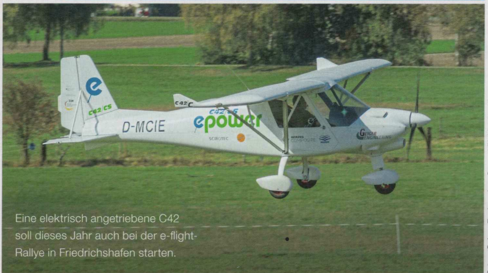
Keine Wartung, sauber, vibrationsfrei und leise: Die Liste der Vorteile eines E-Drives ist lang.
