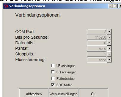
4. Jetzt den Button „Connect“ betätigen und anschließend das Wort „menu“ in die Kommandozeile eintragen und mit dem Button „Senden“ oder mit Taste Return bestätigen. Es erscheint der Menüaufbau im Ausgabefenster:
