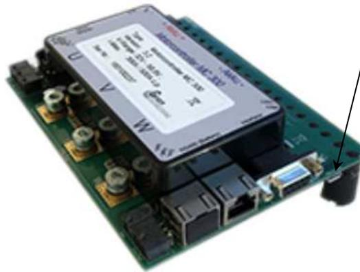
Micro-USB-Kabel hier einstecken/*insert micro usb cable here*
